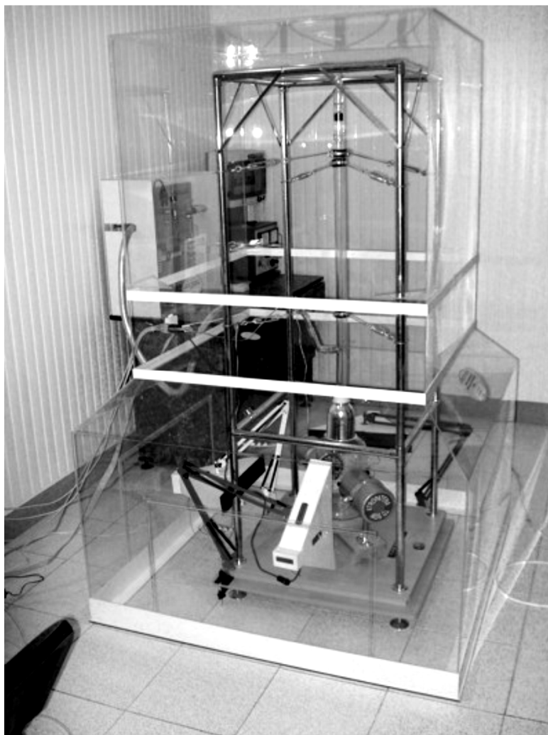
Рис. 53. Фотография Торсионного Детектора Длиннопериодных Гравитационных Вариаций (ТД ДГВ - ATROPATENA), расположенного на станции прогнозирования землетрясений НИИ прогнозирования и изучения землетрясений (г. Баку).
